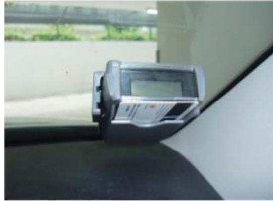
写真 2-2 : 車載器 (In-Vehicle Unit)
